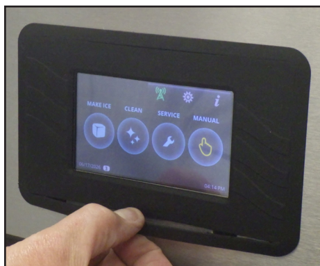
Рис. 1. Снять кольцо дисплея с устройства.
