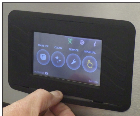
Afb. 1. Trek de ring van het display uit het apparaat.
