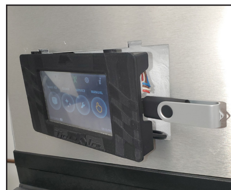
Fig. 2. Posizione della porta USB e dei cavi.
