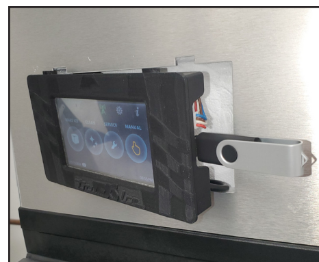
Fig. 2. Emplacements des ports USB et des câbles.
