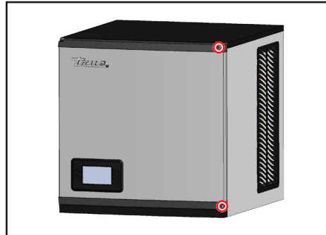
Abb. 1. Position der Schrauben an der Vorderseite.
