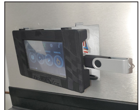
Abb. 2. Position des USB-Anschlusses und der Kabel.
