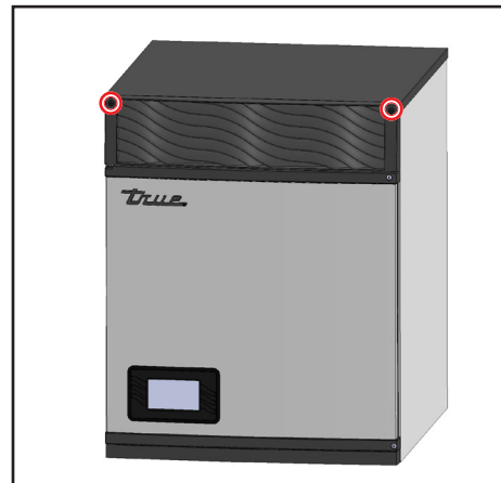
Abb. 1. Position der Schrauben des vorderen Filtergitters.
