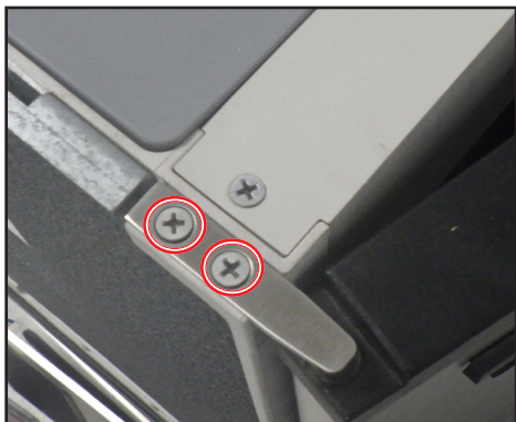
Fig. 5 Posizionamenti delle viti del cardine superiore.
