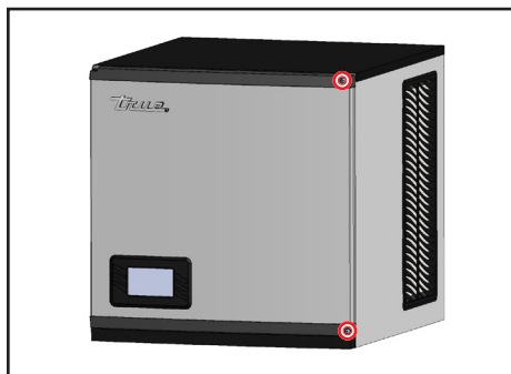
Fig. 1. Emplacements des vis du panneau avant.
