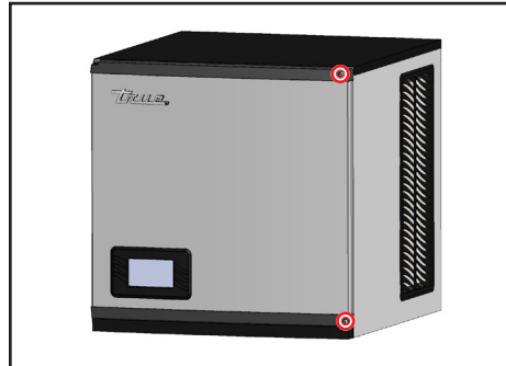
Abb. 1. Position der Schrauben an der Vorderseite.
