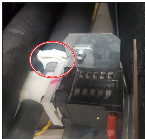
Рис. 3. Снять хомуты крепления шлангов.
