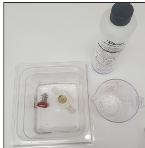
Рис. 2. Поместить корпус клапана и плунжерный узел в раствор.
