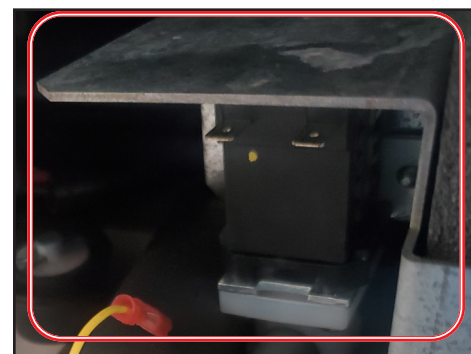
Рис. 2. Закрепить узел на монтажном кронштейне и прикрепить его к льдогенератору.
