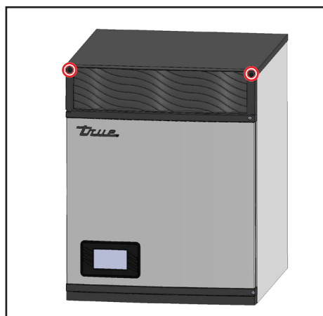
Afb. 3. Locaties van de schroeven van het filterrooster aan de voorzijde.
