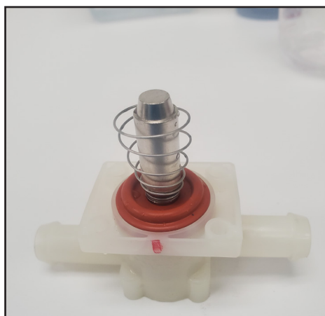
Afb. 3. Spoel alle ontkalker van de kraanbehuizing en de plunjer.
