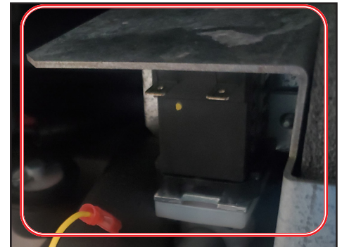
Afb. 2. Bevestig het geheel aan de montagebeugel en maak de aftapkraan vast aan de ijsmachine.
