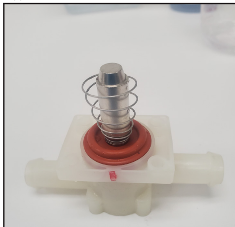
Fig. 3. Risciacquare il corpo valvola e il gruppo pistone per rimuovere tutto il disincrostante.
