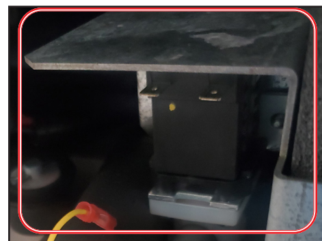
Fig. 2. Fissare il gruppo alla staffa di montaggio e collegare il gruppo alla macchina del ghiaccio.
