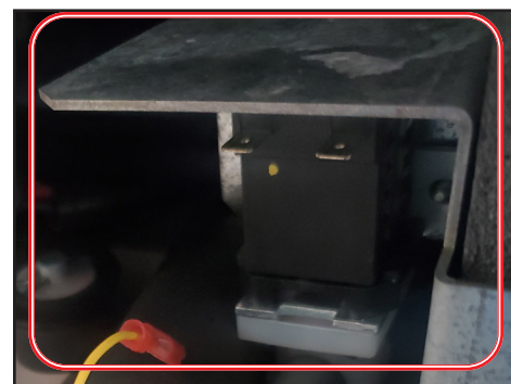
Fig. 2. Fixez l'ensemble au support de montage et fixez l'ensemble à la machine à glaçons.
