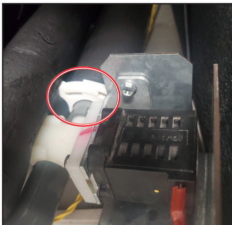
Fig. 3. Déposez les colliers de serrage de tuyau.
