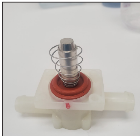
Fig. 3. Rincez tout le détartrant du corps de la vanne et de l'ensemble de plongeur.
