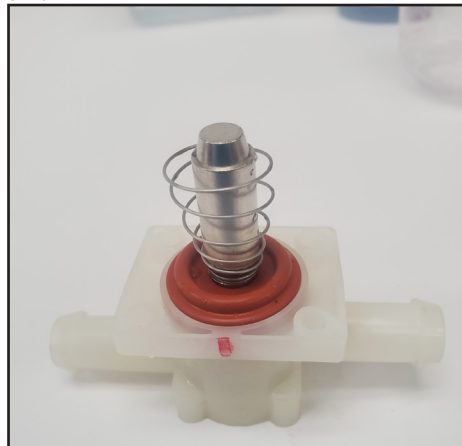
Fig. 3. Enjuague bien el cuerpo de la válvula y el conjunto del émbolo para eliminar cualquier resto de desincrustante.
