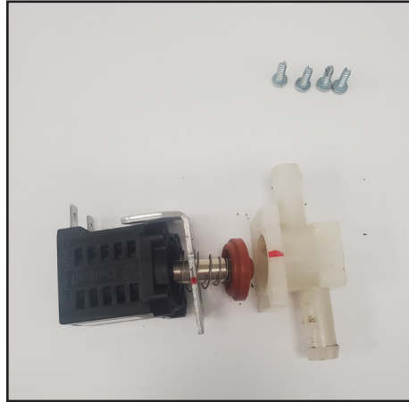
Abb. 3. Trennen Sie die Spule, die Halterung, die Kolbenbaugruppe und den Ventilkörper.
