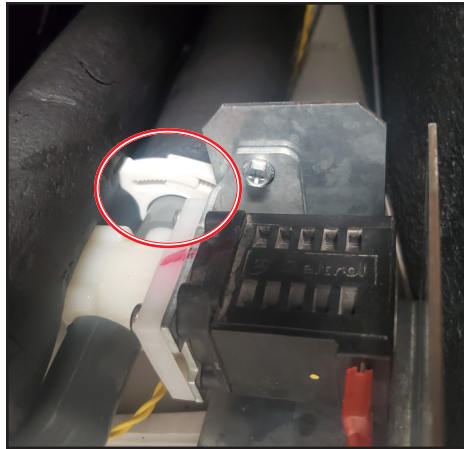
Abb. 3. Entfernen Sie die Schlauchklemmen.
