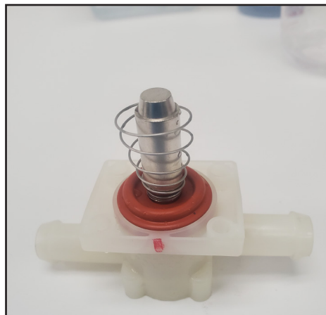
Abb. 3. Spülen Sie den Entkalker von dem Ventilgehäuse und der Kolbenbaugruppe ab.
