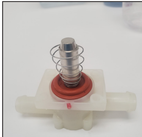
الشكل 3. اشطف جميع آثار مزيل الترسبات عن جسم الصمام ومجموعة المكبس.
