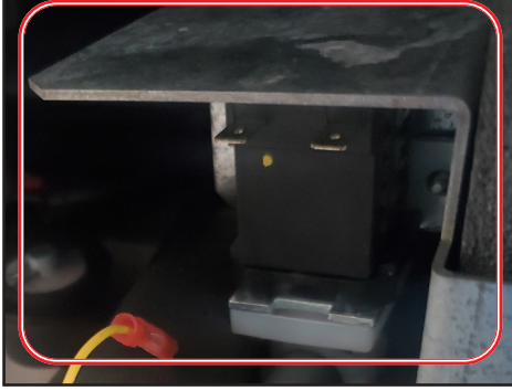
الشكل 2. ثبت المجموعة على دعامة التثبيت، ثم قم بتوصيلها بآلة الثلج.
