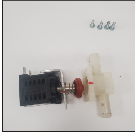
الشكل 1. قم بإعادة تركيب الملف، والدعامة، ومجموعة المكبس، وجسم الصمام.
