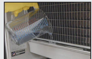
Fig. 3. Pour descaler into the sump tank.
