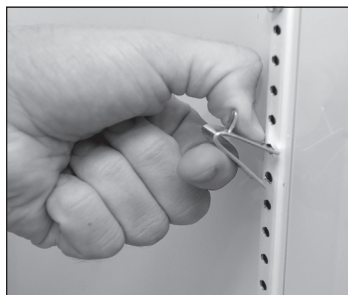
Рис. 2. Нижняя часть зажима для полки устанавливается с нажимом.
