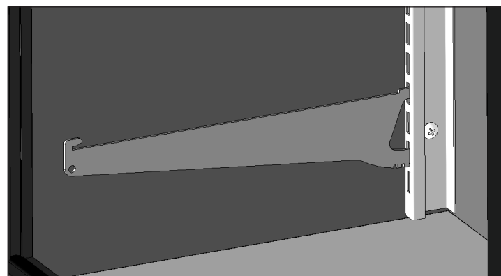
Рис. 8. Установленный опорный кронштейн полки.
