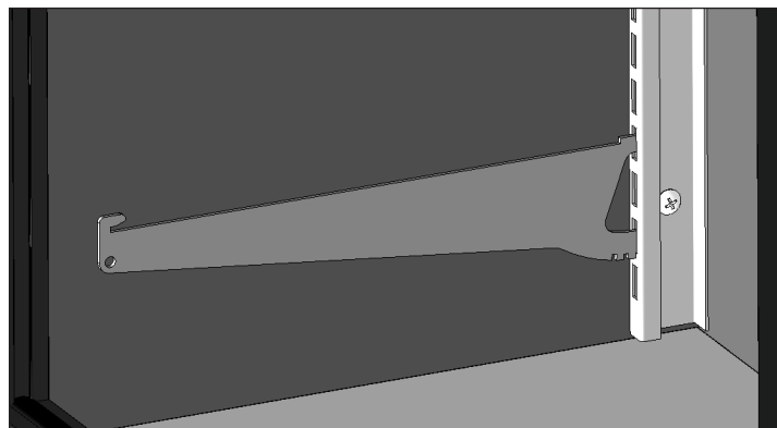
Rys. 14. Zamontowany uchwyt wspornikowy półki.
