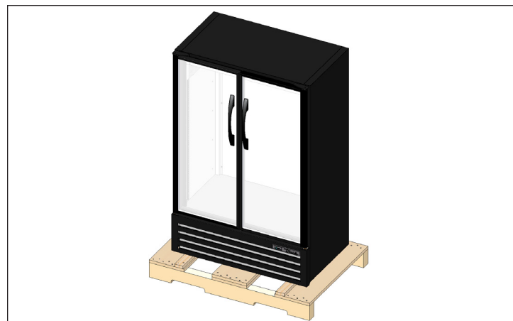
Rys. 4. Podczas podnoszenia urządzenia nie należy wykorzystywać blatów, drzwi/szuflad ani krerek jako punktu podnoszenia.
