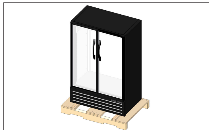
Afb. 4. Gebruik bij het optillen van het apparaat nooit het werkblad, de deuren, de laden of de roosters als hijspunt.
