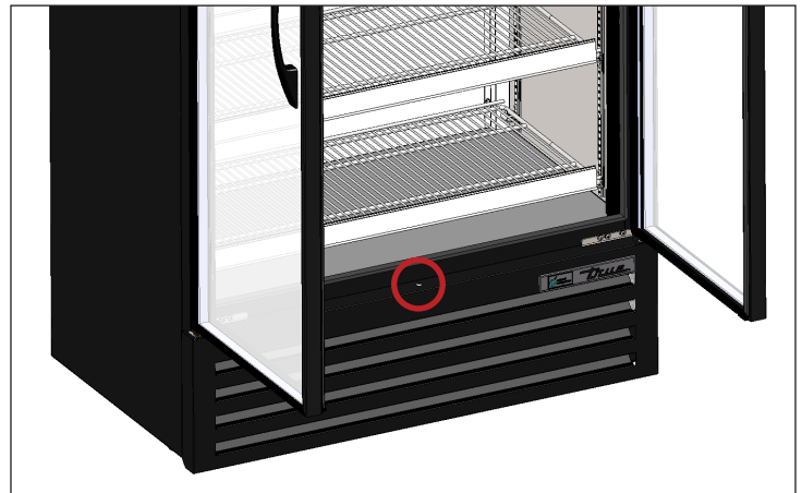
Afb. 2. Locatie van de schroef voor het ventilatierooster aan de voorkant.
