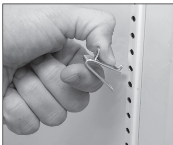
Fig. 1. Installazione della linguetta superiore della clip per ripiani.
