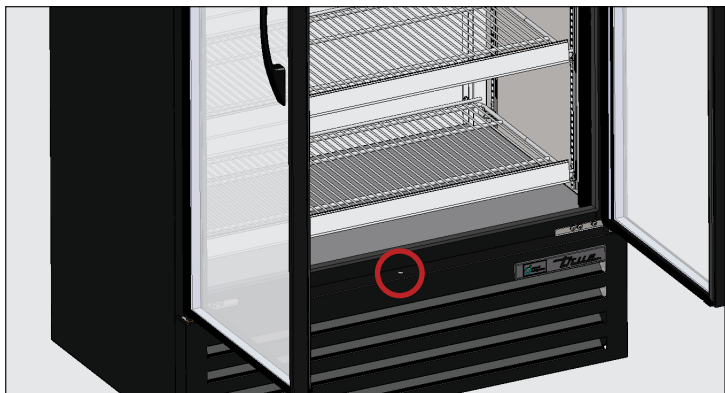
Fig. 1. Emplacement des vis de la grille de ventilation de la porte à battant.
