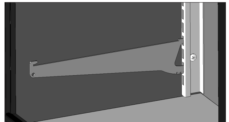
Fig. 8. Fixation de support de clayette installée.
