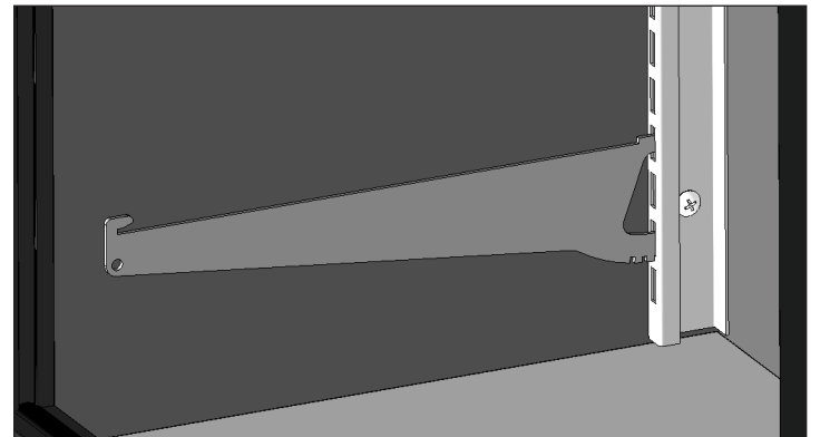
Fig. 14. Ménsula del estante instalada.
