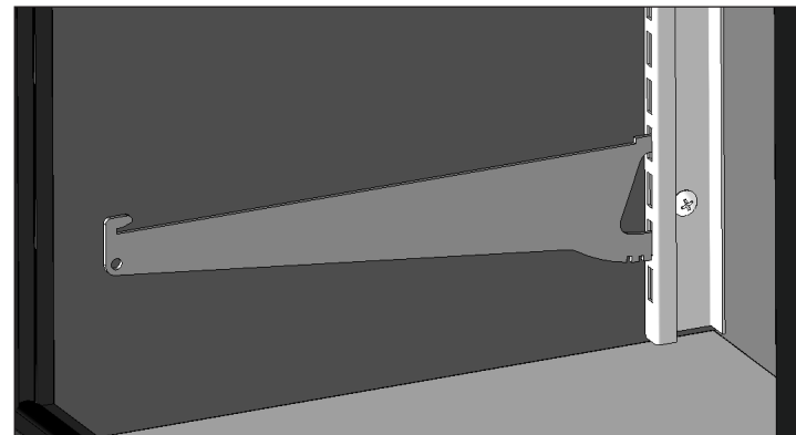
Fig. 8. Ménsula del estante instalada.
