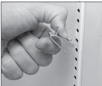
Abb. 1. Befestigung der oberen Lasche des Halters.
