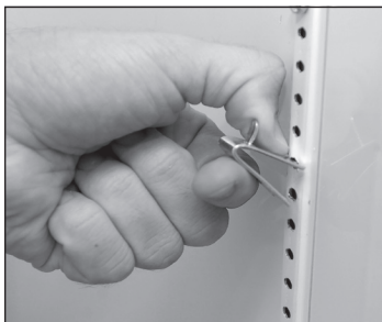
Abb. 2. Die untere Lasche des Halters passt genau in die entsprechende Aufnahmebohrung.
