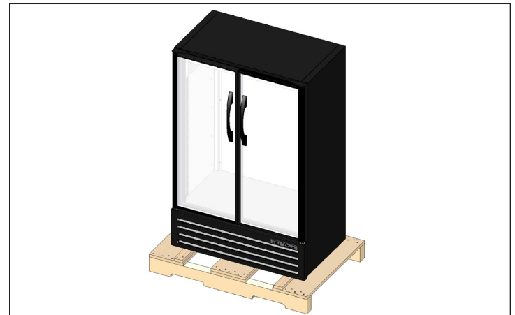
Abb. 4. Beim Anheben des Geräts nicht an den Arbeitsplatten, Türen/Schubladen oder Gittern anfassen.
