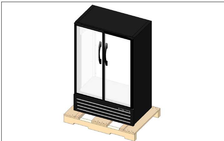
الشكل ٤. عند رفع الوحدة لا تستخدم الأسطح العلوية، أو الأبواب/الأدراج، أو الشبكات كنقطة رفع.
