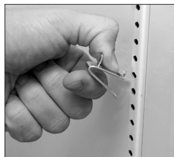
Рис. 1. Установка верхней части зажима для полки.
