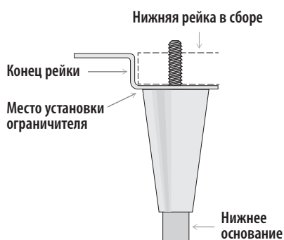
Рис. 4. Схема ножки для выравнивания.
