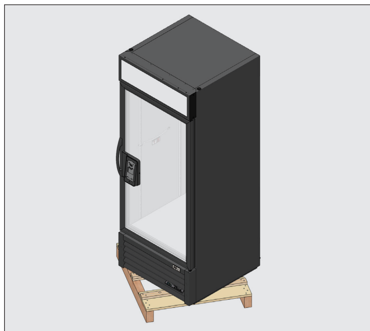
Rys. 5. Podczas podnoszenia urządzenia nie należy wykorzystywać blatów, drzwi/szuflad ani kratek jako punktu podnoszenia.
