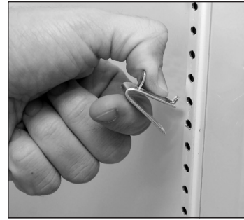
Abb. 1. Befestigung der oberen Lasche des Halters.
