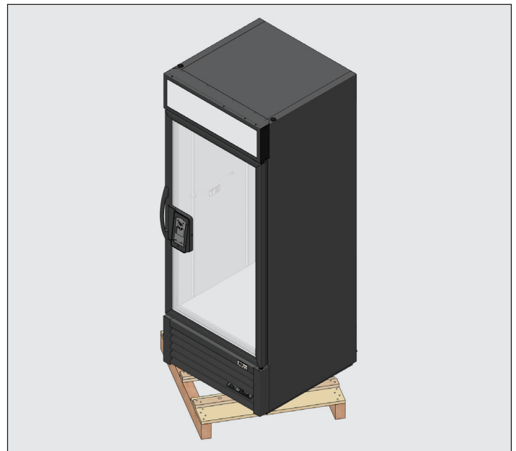
Abb. 5. Beim Anheben des Geräts nicht an den Arbeitsplatten, Türen/Schubladen oder Gittern anfassen.
