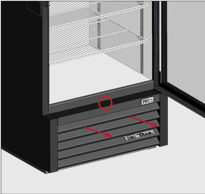
Fig. 3. Ubicación de los tornillos de la rejilla frontal. Retire con cuidado la rejilla de los imanes.
