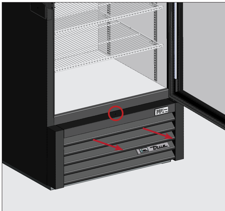
Fig. 3. Emplacement des vis de la grille de ventilation avant. Retirez délicatement la grille des aimants.
