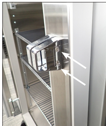
Рис. 5. Местонахождение винтов крепления защелки.
