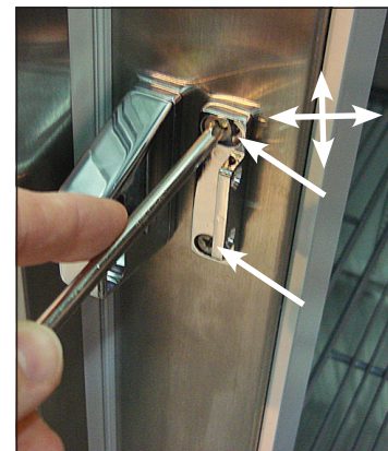
Рис. 6. Местонахождение винтов крепления основания замка. Отрегулировать положение основания замка согласно необходимости.
