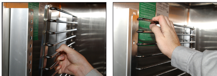
Рис. 7b. Установка стержневых направляющих (комплект №2)
