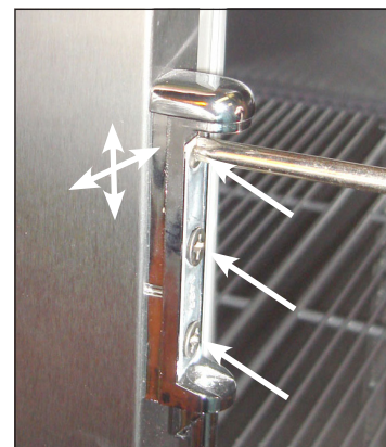
Рис. 4. Местонахождение винтов крепления петли на дверце. Отрегулировать положение петли согласно необходимости.
