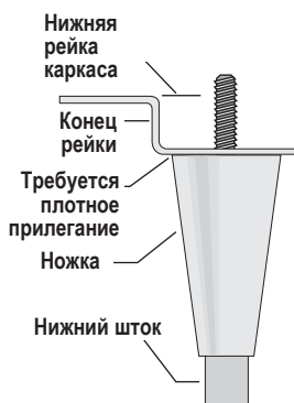
Рис. 4. Вкрутить регулируемые ножки.
