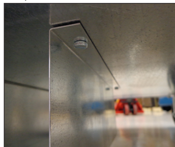
Fig. 3: Prenda o suporte da BCA no lado inferior do gabinete.
