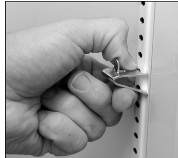
Fig. 3: Você pode precisar apertar ou torcer o fundo do grampo de prateleira para instalar.
