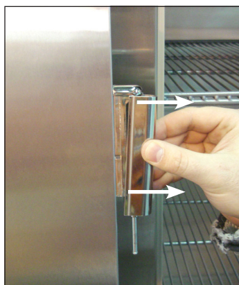
Fig. 3: Puxe a cobertura da dobradiça da porta.
