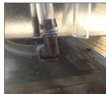
Fig. 6: Acople as conexões farpadas às mangueiras do gabinete.
