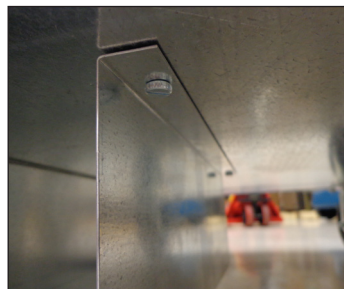
Afb. 3. Bevestig de HDP-beugel aan de onderkant van de kast.
