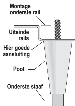
Afb. 5. Draai de onderste staaf om de kast te nivelleren.
