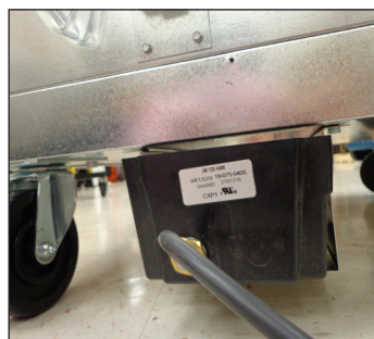
Fig. 4. Porre l'HDP nel supporto dell'HDP.
