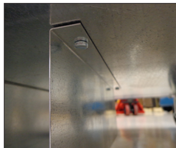
Fig. 3. Assicurare il support dell'HDP al lato inferiore dell'armadietto.
