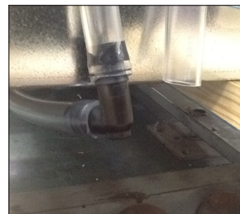
Fig. 6. Connettere il raccordo filettato ai tubi sull'armadietto.
