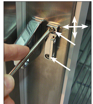
Fig. 6. Emplacements des vis de la base de la gâche. Déplacez la base selon les besoins.
