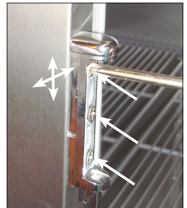
Fig. 4. Emplacements des vis des charnières de la porte. Déplacez la charnière selon les besoins.
