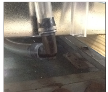
Abb. 6. Schließen Sie die Stecknippelverschraubung an den Schläuchen im Schrank an.
