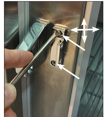
Abb. 6. Orte der Schlosssockelschrauben. Bewegen Sie den Sockel, falls nötig.
