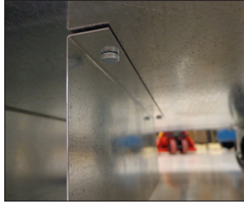
الشكل 3. قم بثبيت رف وعاء الصرف الساخن ذو الدعامه بالجانب السفلي للخزانة.
