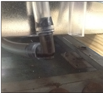
الشكل 6. قم بتوصيل التركيبات الشانكة بالخراطيم الموجودة على الخزانة.
