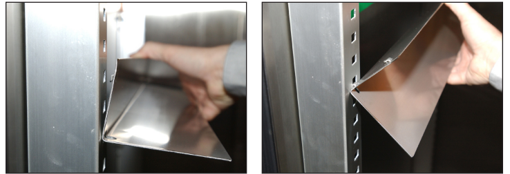
الشكل 7 ج. تركيب المجموعة رقم 3 لجوانب الأدراج الكاملة.
