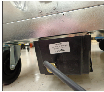
الشكل 4. قم بتهيئة وعاء الصرف الساخن في رف وعاء الصرف الساخن ذو الدعامه.
