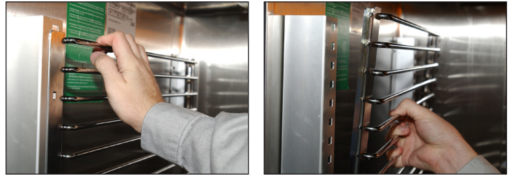
الشكل 7 ب. تركيب المجموعة رقم 2 لجوانب الأدراج على شكل قضيب.
