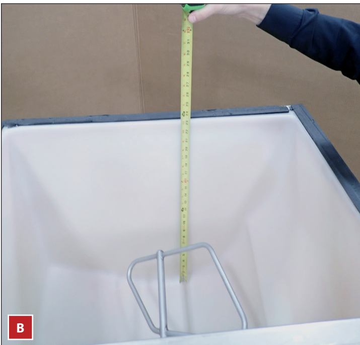
Fig. 2. Mida siempre el depósito (A) o el dispensador (B) para el sensor TOF antes de colocar el modelo TCIM.
