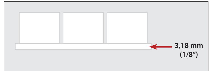
Fig. 1. El puente de hielo mantiene unidos los cubos de hielo.
