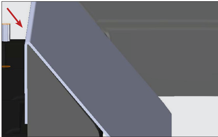
Fig. 9. Vista lateral del deflector de zona de caída instalado.
