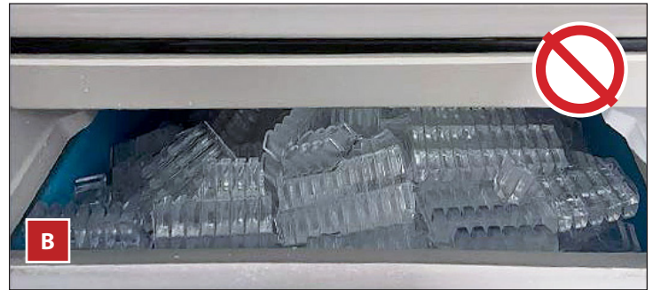
Fig. 10. Depósitos de hielo con (A) y sin (B) deflector de zona de caída.
