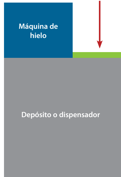
Fig. 5. Modelo TCIM instalado en el costado izquierdo del depósito o dispensador.
