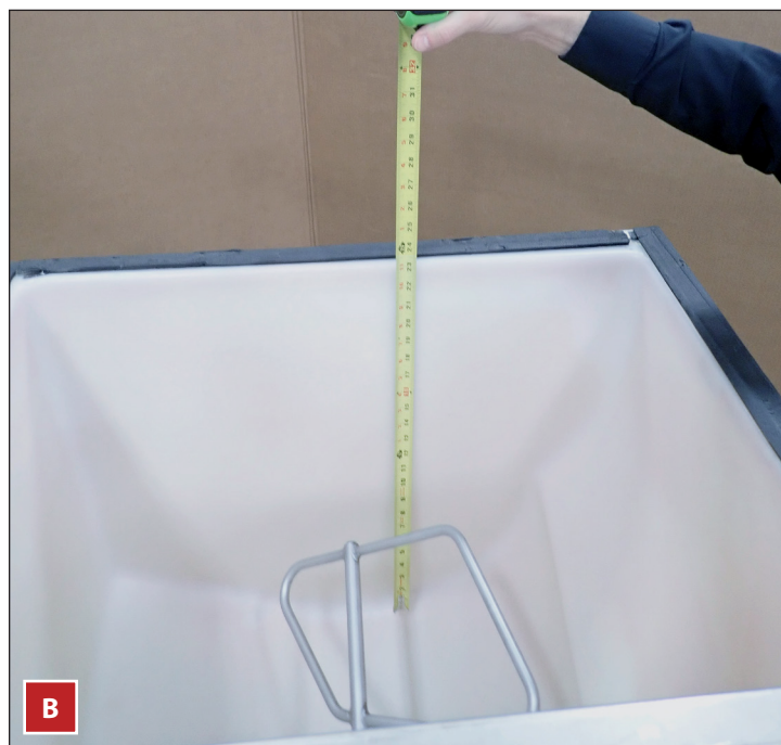
Рис. 2. Перед установкой льдогенератора TCIM обязательно измерить контейнер (A) или диспенсер (B) для настройки датчика TOF.
