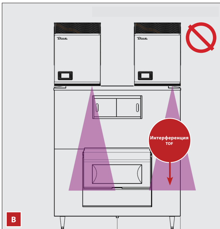
Рис. 7. Всегда устанавливайте адаптер для контейнера (необходимый размер зависит от области применения) между TCIM и правым краем контейнера/диспенсера (А), чтобы предотвратить помехи TOF (В) и неправильную работу.
