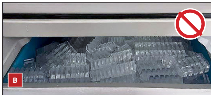
Рис. 10. Контейнер для хранения льда с дефлектором (А) и без дефлектора (В) зоны выдачи льда.
