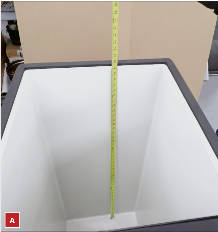
Рис. 3. Перед установкой льдогенератора TCIM проверить уровень льда в резервуаре.
