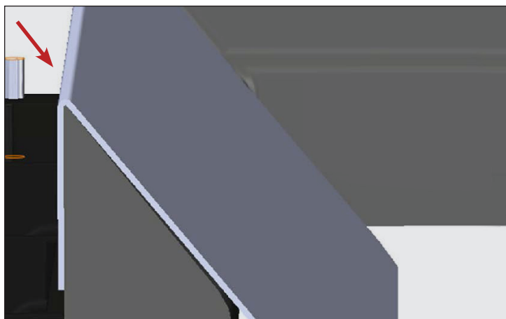
Рис. 9. Установлен дефлектор зоны выдачи льда, вид сбоку.
