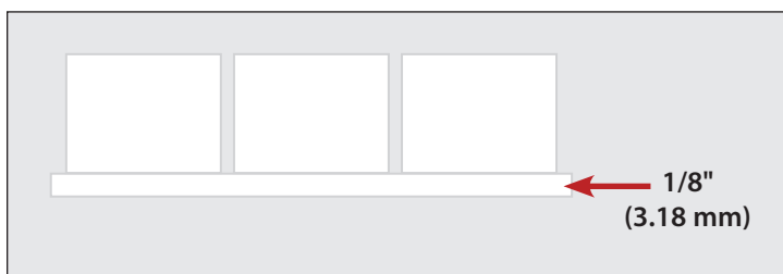
Rys. 1. Mostek lodowy scala kostki lodu w bloku.
