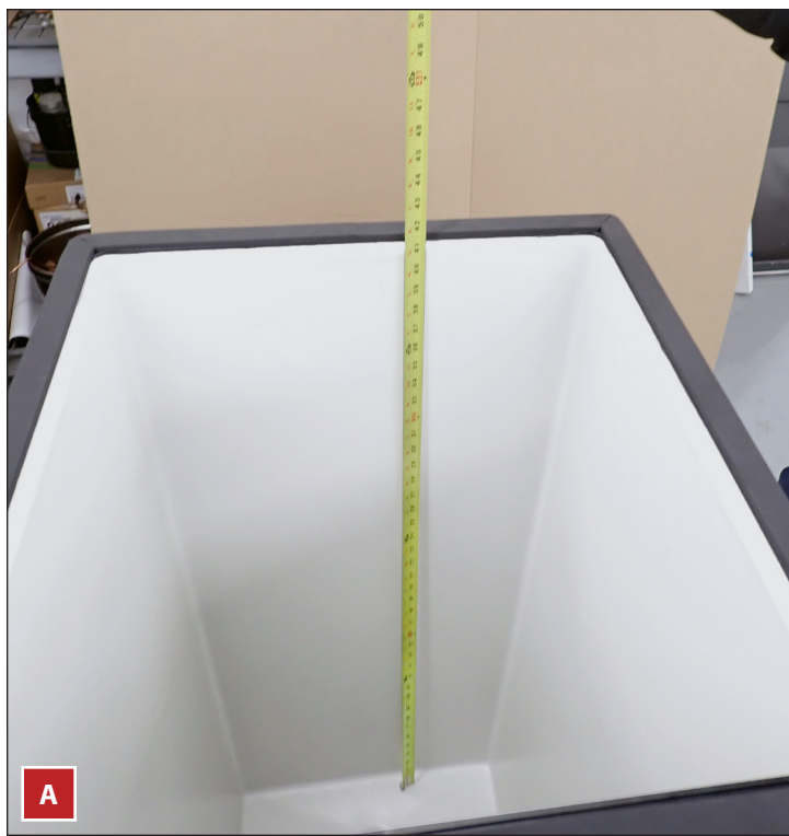
Rys. 3. Przed umieszczeniem kostkarki sprawdzić poziom przechowywanego lodu.
