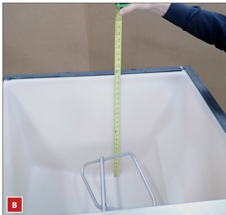
Rys. 2. Zawsze przed umieszczeniem kostkarki należy zmierzyć zasobnik (A) lub podajnik (B) pod kątem wymagań dotyczących czujnika TOF.
