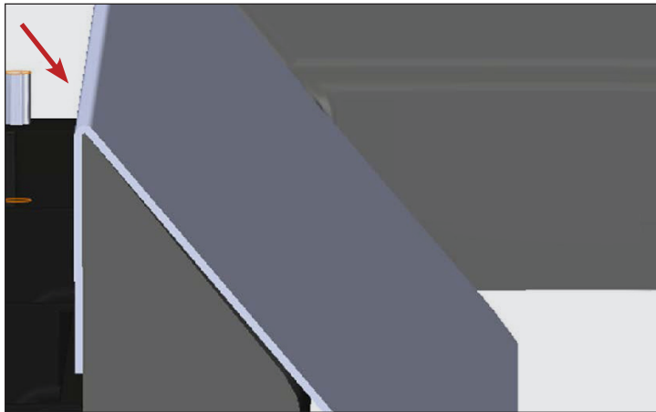
Afb. 9. Zijaanzicht met deflector voor afgiftezone aangebracht.
