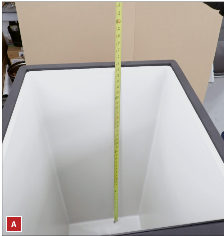
Fig. 3 Verificare il livello del serbatoio del ghiaccio prima di posizionare il TCIM.
