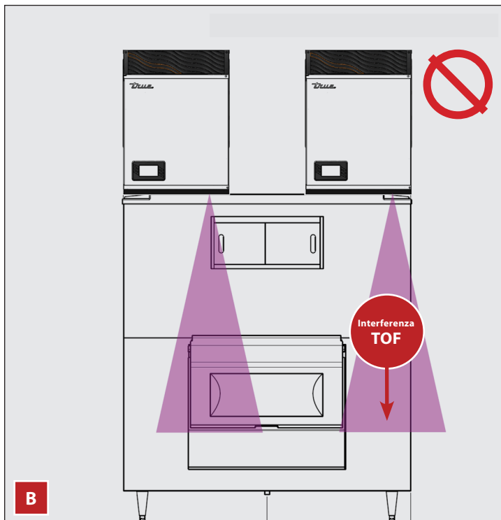
Fig. 7 Installare sempre un adattatore per contenitore (le dimensioni richieste variano in base all'applicazione) tra il TCIM e il bordo destro del contenitore/dispenser (A) per prevenire interferenze TOF (B) e malfunzionamenti.
