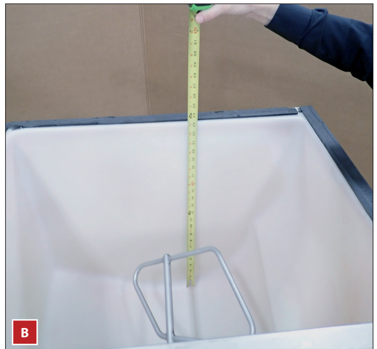
Fig. 2 Misurare sempre il contenitore (A) o il distributore (B) per il sensore TOF prima di posizionare il TCIM.
