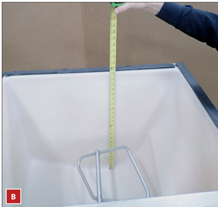
Fig. 2 Misurare sempre il contenitore (A) o il distributore (B) per il sensore TOF prima di posizionare il TCIM.
