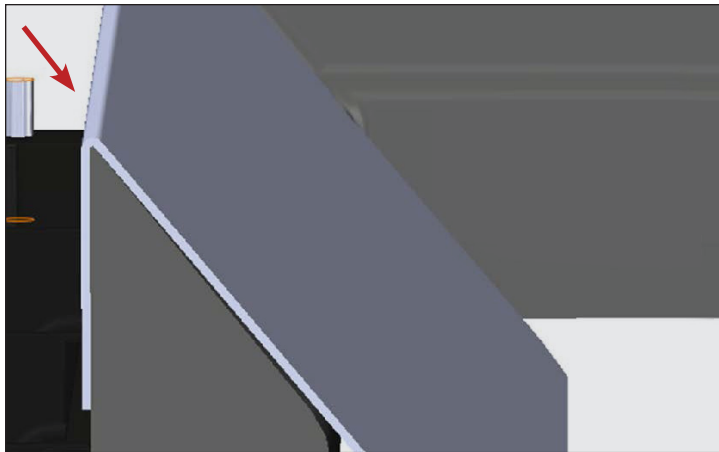
Fig. 9 Visione di lato del deflettore della zona di rilascio installato.
