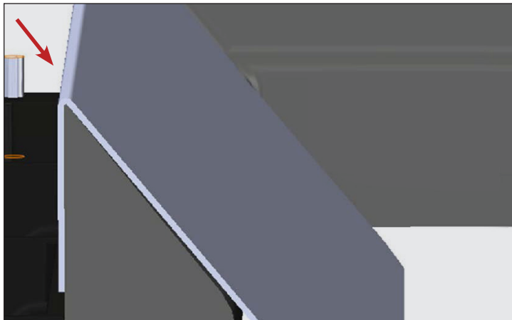
Abb. 9. Seitenansicht des installierten Abweisers im Ausgabebereich.
