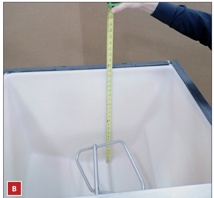
Abb. 2. Messen Sie immer den Behälter (A) oder Spender (B) für den TOF-Sensor, bevor Sie das TCIM aufstellen.
