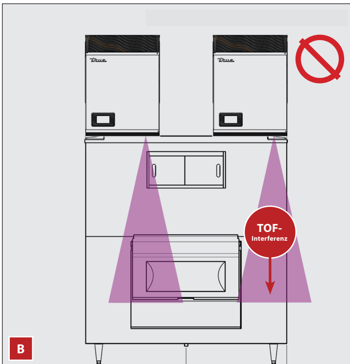
Abb. 7. Montieren Sie immer einen Behälteradapter (erforderliche Größe variiert je nach Anwendung) zwischen dem TCIM und der rechten Kante des Behälters/Spenders (A), um TOF-Interferenz (B) und inkorrekten Betrieb zu verhindern.
