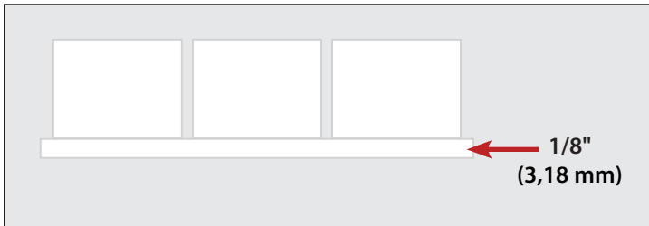
Abb. 1. Die Eisbrücke hält die Eiswürfel zusammen.
