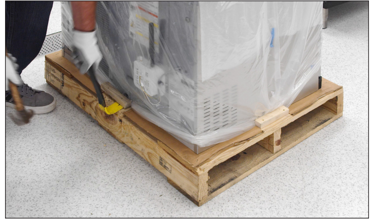
Figure 1. Déposer les cales en bois de la palette.
