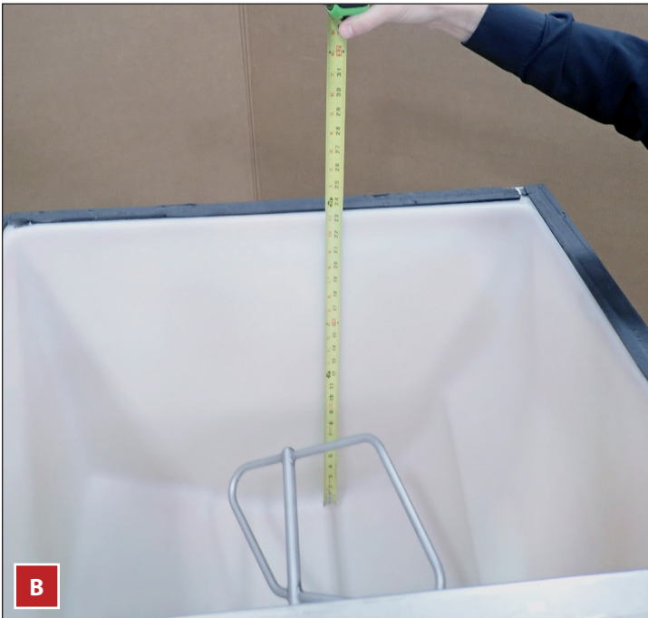
Figure 2. Toujours mesurer le bac (A) ou le distributeur (B) pour le capteur TOF avant de positionner la machine TCIM.
