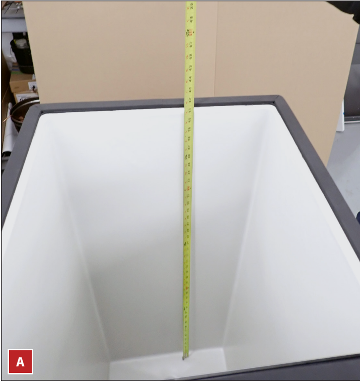
Figure 3. Vérifier le niveau du stockage de glaçons avant de positionner la machine TCIM.
