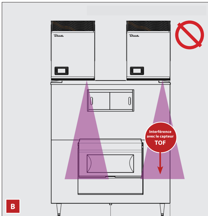
Figure 7. Toujours installer un adaptateur de bac (la dimension nécessaire dépend de l'application) entre la machine TCIM et le côté droit du bac/distributeur (A) pour éviter l'interférence avec le capteur TOF (B) et un fonctionnement incorrect.
