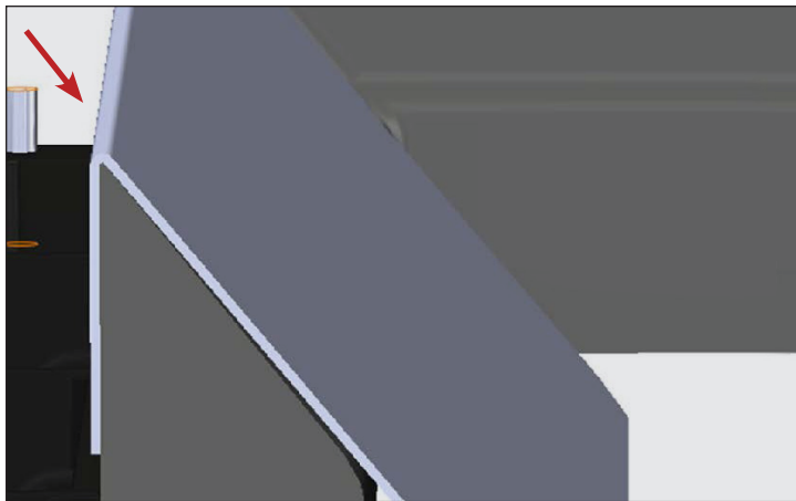
Figure 9. Vue latérale du déflecteur de zone de dépôt installé.
