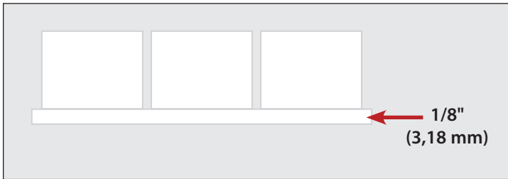
Figure 1. Le pont de glace maintient les glaçons ensemble.
