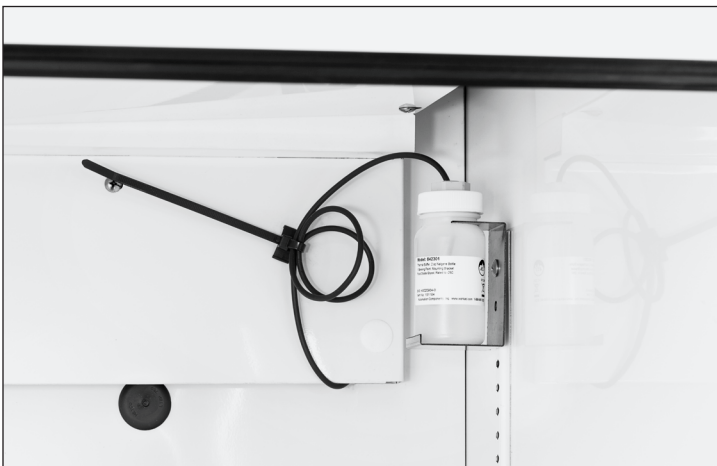
Fig. 3. Installation verticale ; TRUE recommande de poser le bidon de glycol en haut de l'installation standard de l'étagère arrière droite comme indiqué dans l'illustration. Support de bidon de glycol monté avec une vis standard existante des étagères.
