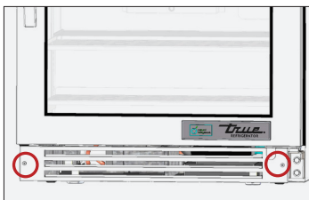
Fig. 6. Emplacements des vis de la grille de ventilation avant du sous-comptoir. Une fois les vis retirées, la grille reste en place grâce à un système magnétique.
