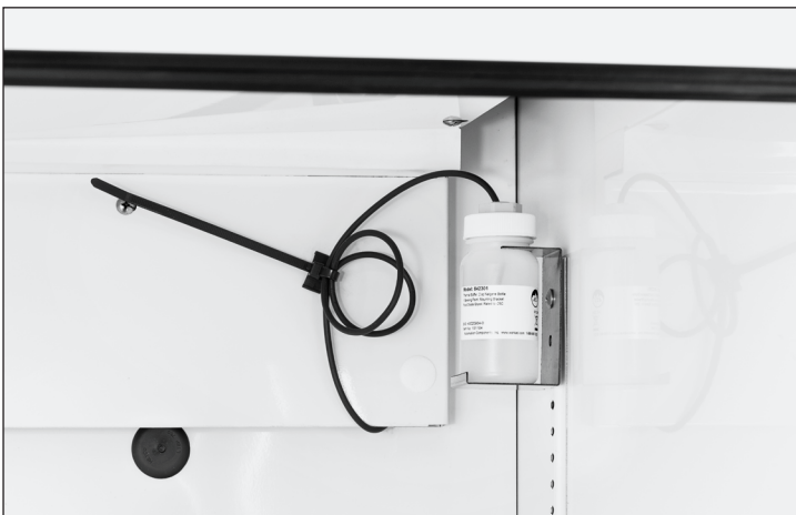
Fig. 3. Vertical. TRUE recomienda instalar el conjunto de botella de glicol en el extremo superior del perfil para estantes trasero derecho , tal y como se muestra en la figura. Soporte para la botella de glicol instalado con un tornillo estándar del estante.
