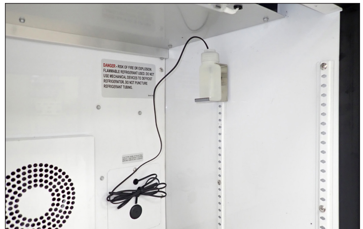
Fig. 4. Bajo mostrador. TRUE recomienda instalar el conjunto de botella de glicol en el extremo superior del perfil para estantes trasero derecho , tal y como se muestra en la figura. Soporte para la botella de glicol instalado con un tornillo estándar del estante.
