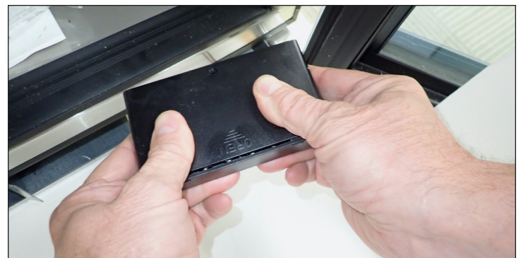
Fig. 8. Abrir la tapa de la batería deslizando la tapa.
