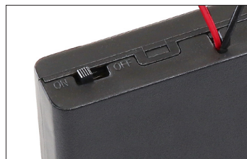
Fig. 7. Batería de reserva conmutada a ON (encendido).
