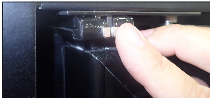
Fig. 12. Insérez le clip de maintien de la charnière.
