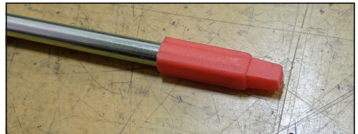
Fig. 21. Capuchon de la tige de torsion.
