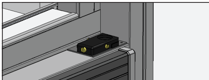
Fig. 27. Ensemble de réglage de la fermeture de porte (torque master) posé correctement.
