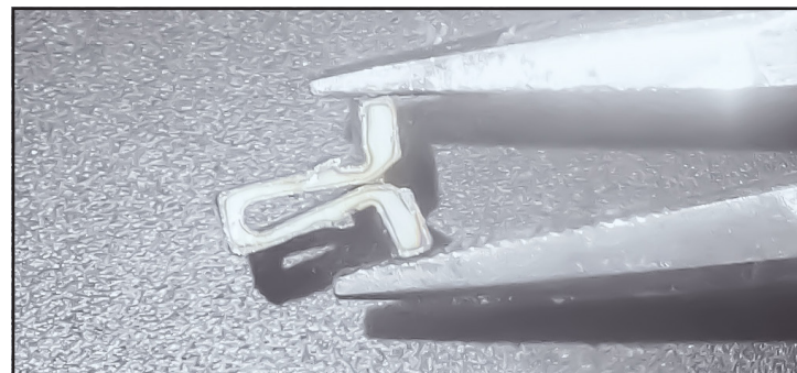
Fig. 10. Pressez le clip de maintien de la charnière.
