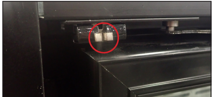
Fig. 6. Clip de maintien de la charnière installé dans la charnière supérieure. Comprimez le clip avec une pince et tirez.
