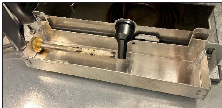
Fig. 2. Placez le BPC sous l'embout d'évacuation de trop-plein.
