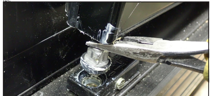
Fig. 8. Un assistant soulevant la tige de torsion du trou du dispositif de réglage de la fermeture de porte (torque master) pendant que le technicien soulève la porte.
