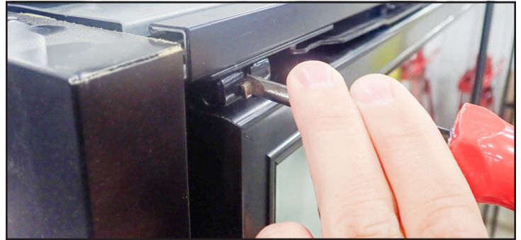
Fig. 14. Abra el clip de retención de la bisagra.
