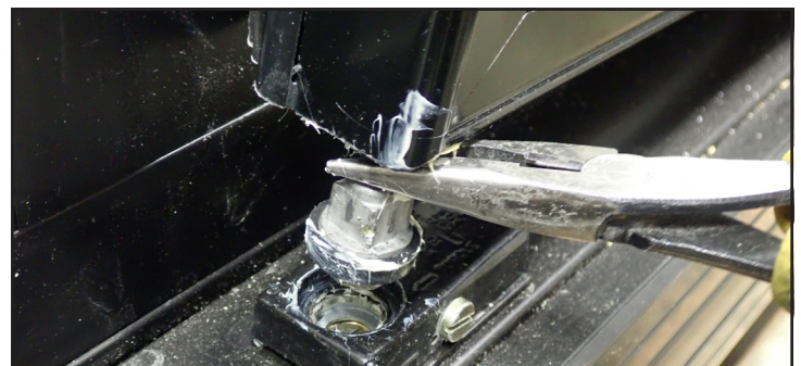
Fig. 8. Ayudante levantando la barra de torsión del orificio maestro de torsión mientras el técnico levanta la puerta.
