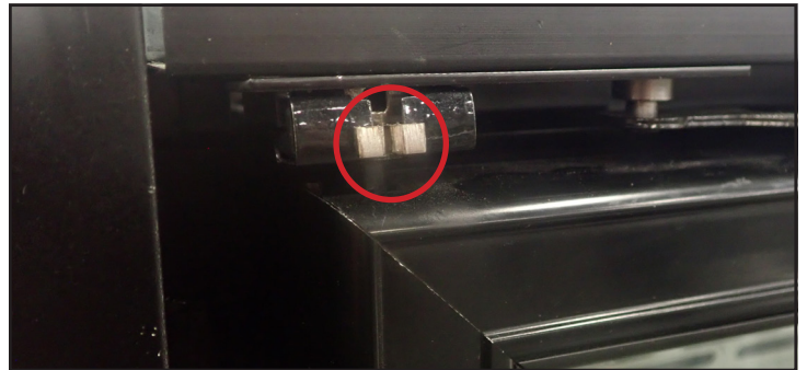
Fig. 6. Clip de retención de la bisagra instalado en la bisagra superior. Comprima el clip con unos alicates y tire.
