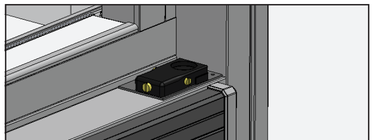
Fig. 27. Conjunto maestro de torsión de repuesto correctamente instalado.
