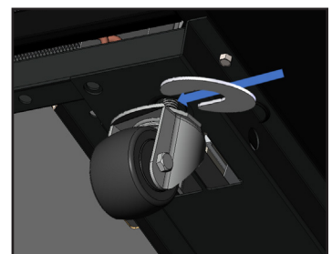
Fig. 7. Coloque la(s) cuña(s).
