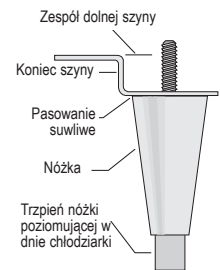
Rys. 4. Wkręcić nóżki poziomujące.
