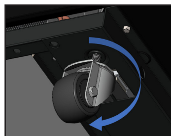
Rys. 8. Umieścić podkładki obrócone o 90° jedna względem drugiej.
