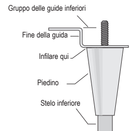
Fig. 4. Avvitare le gambe di livellamento.
