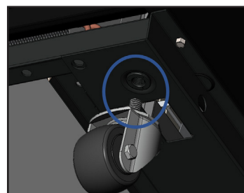
Fig. 6. Allentare i bulloni delle rotelle.
